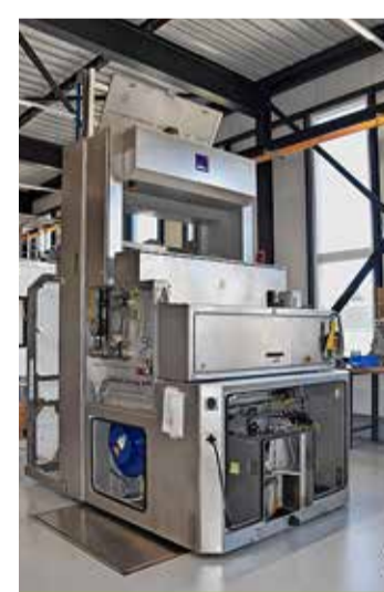
Le robot RF4 est un modèle conséquent qui peut froter de 3 à 4 fromages en même temps. S. DEILLON
